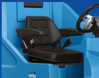
Sedile regolabile con braccioli e cintura di sicurezza
